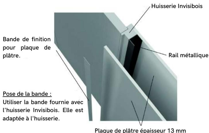
Lorsque les bandes et la finition sur la cloison sont réalisées, présenter la porte et installer les charnières invisibles.
