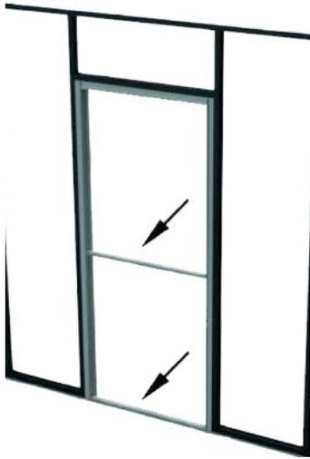
Monter votre cloison avec rails adaptés aux plaques de plâtre type BA-13.
